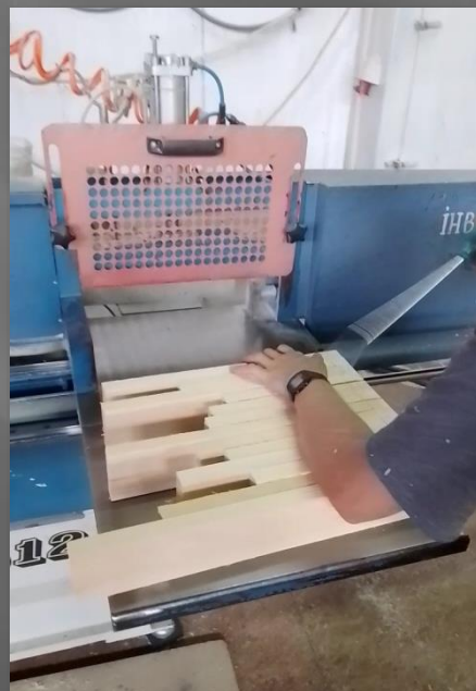
«Фрезерування деталей для виготовлення шипового з'єднання на мікрошип»
