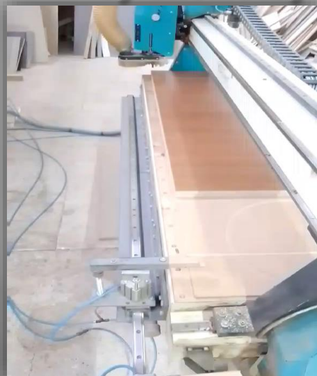
«Фрезерування деталей для виготовлення шипового з'єднання на мікрошип»
