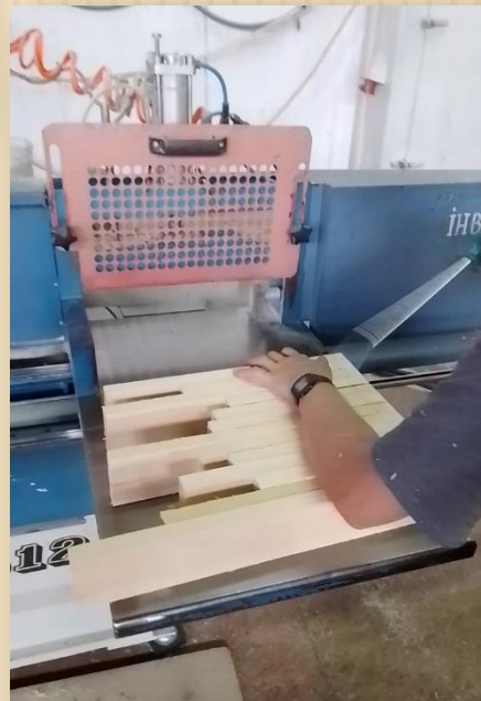
«Фрезерування деталей для виготовлення шипового з'єднання на мікрошип»
